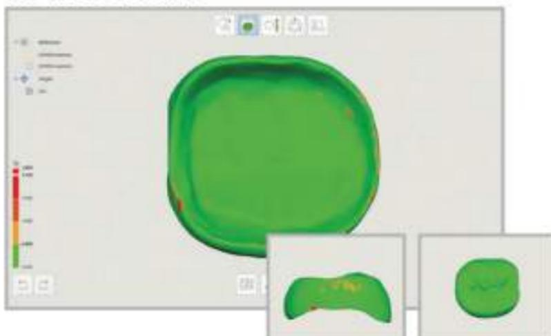
Esegue un adattamento della corona senza bisogno del modello. Il software può rivelare dove potrebbero essere necessarie modifiche.
