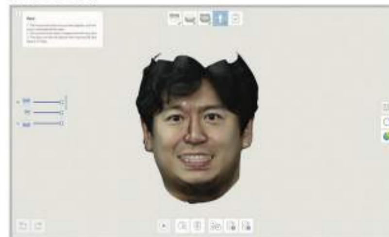
Scansiona il viso del paziente, importa i dati 3D del viso e delle ossa, e allinea tutti questi set di dati per ottenere un risultato finale più completo.
