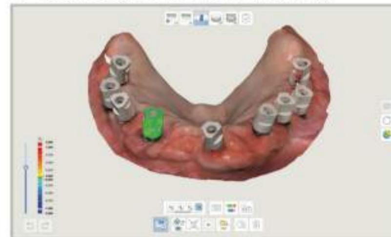
I monconi e gli scanbody vengono automaticamente abbinati e allineati con i dati di scansione. Utilizzare questa funzione per flussi digitali CAD CAM.
